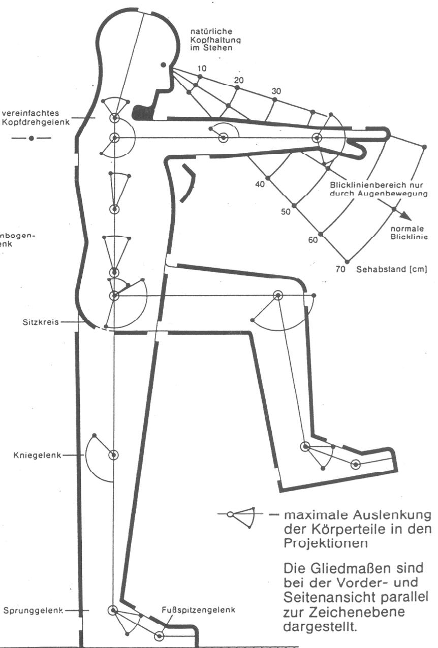
maximale Auslenkung der Körperteile in den Projektionen
